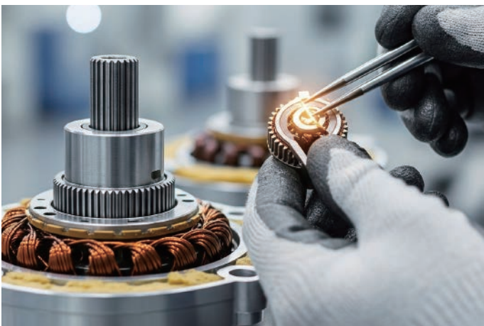
モーターのオーバーホール
